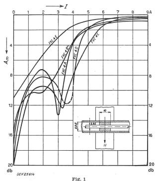
Gemessene Betriebsdämpfung verschiedener Ferrite  $A_m$  Dämpfung; H magnetisches Gleichfeld; I Magnetisierungsstrom; FXC 4A...E verschiedene Ferrit-Materialien
