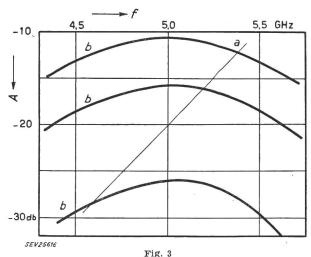
Frequenzabhängigkeit der Dämpfung für einen kompensierten Attenuator
