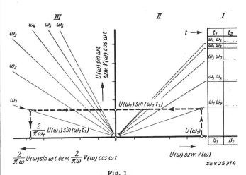
Aufbau des Nomogramms zur Berechnung des Integranden
