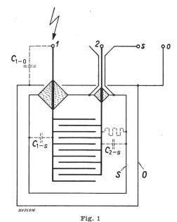
Aufbau des Normalkondensators
