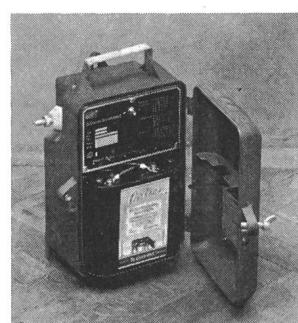
Appareil pour clôtures électriques de pâturages, selon figure. Coffret en fonte de silumin renfermant une pile sèche, un interrupteur, un relais, un condensateur de charge et un transformateur d'impulsions, pour la production d'impulsions de tension répétées.
