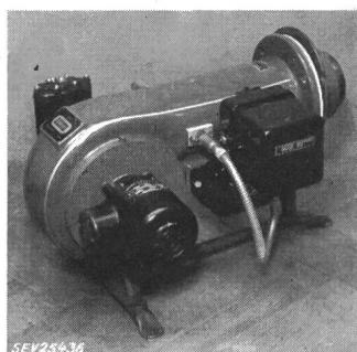
Amenée de l'air par ventilateur. Entraînement par moteur triphasé à induit en court-circuit. Commande par appareil automatique avec cellule photoélectrique. Clapet pour le réglage automatique de l'air. Dispositif de déparasitage.
