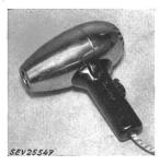
Sèche-cheveux, selon figure. Soufflante avec hélice en matière isolante, entraînée par moteur monophasé série. Résistance boudinée, enroulée autour de corps en matière céramique. Enveloppe en métal léger éloxé, avec poignée en matière isolante moulée. Un commutateur dans la poignée permet un fonctionnement à l'air chaud et à l'air froid. Cordon de raccor-
