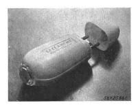
au sélénium avec résistance en série, un condensateur et un petit fusible. Interrupteur. Pour la recharge, la lampe est introduite dans un socle de prise de courant.
