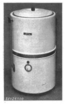
Machine à laver, selon figure, avec chauffage. Cuve à linge émaillée, au fond de laquelle est logé un barreau chauffant. Agitateur constitué par un disque rotatif disposé au fond de la cuve et entraîné par moteur monophasé à induit en courtcircuit, avec enroulement auxiliaire et condensateurs. Interrupteurs pour le moteur et le chauffage. Lampe à effluve. Amenée de courant à trois conducteurs, fixée à la machine, avec fiche 2 P + T.
