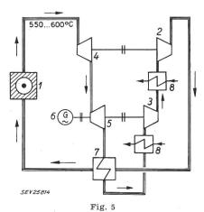
Gasgekühlter Reaktor mit Gasturbinenanlage 1 Reaktor; 2, 3 Hoch- und Niederdruck-Kompressor; 4, 5 Gasturbine; 6 elektrischer Generator; 7 Wärmeaustauscher; 8 Zwischenkühler
