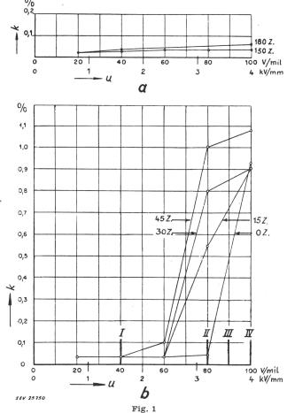
Messergebnisse von zyklischen Alterungsversuchen an verschiedenen 15-kV-PVC-Kabeln
