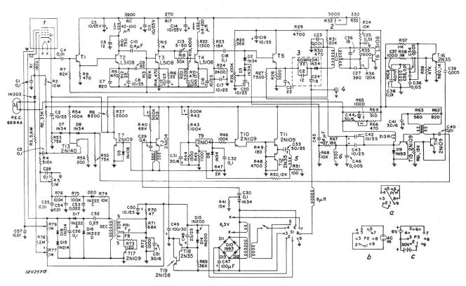
Fig. 1 Schaltung der Kleinfernsehkamera «Transistorized TV Eye» mit 19 Transistoren
