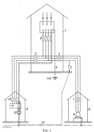
1 Transformatorenstation; 2 Hauptsicherungen; 3 Gruppensicherungen; 4 Sondererdung 11  $\Omega$ ; 5 Erdschluss; 6 Pumpenhaus; 7 Hauptsicherungen; 8 Motor; 9 Liegenschaft; 10 Hauptsicherungen; 11 Verteiltafel; 12 Haubensicherungen; 13 Wasserleitung aus Gussrohr
