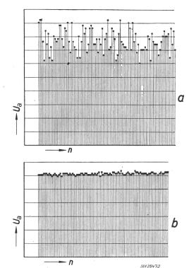
Fig. 6 Streuung der Frontansprechspannung bei einer Steilheit von 100 kV/ $\mu$ s pro 10 kV Ableiternennspannung
