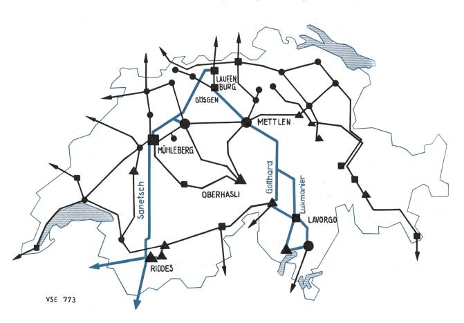
Lignes de transport de plus de  $100\,kV$  mises en service en 1956 ou en construction à la fin de 1956
