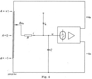
Prinzipschema eines Reaktor-Simulators unter Berücksichtigung nur prompter Neutronen
