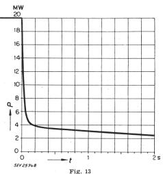
Leistungsabfall beim geplanten Reaktor P 34 bei sprungförmiger Anderung der Nullreaktivität um — 3400 pcm unter Berücksichtigung aller Effekte
