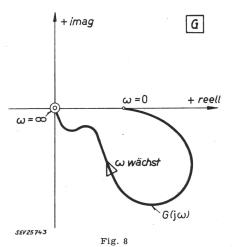
Frequenzgang  $G(j\omega)$  eines Reaktors unter Berücksichtigung der prompten und verzögerten Neutronen und negativer Temperaturkoeffizienten
