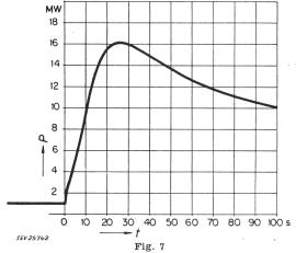
Leistungsanstieg P beim geplanten Reaktor P 34 bei sprungförmiger Änderung der Nullreaktivität um + 400 pcm unter Berücksichtigung aller Effekte
