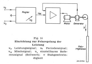
eine generatorische Gegenkopplung sorgen für eine dem Mischsignal  $u_M$  proportionale Feinregelstabgeschwindigkeit v:
