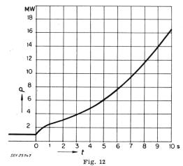
Leistungsanstieg beim geplanten Reaktor P 34 bei sprungförmiger Anderung der Reaktivität von Null auf 400 pcm unter Vernachlässigung des Temperatureffektes
