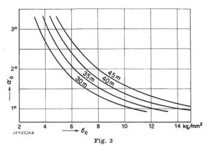
Zickzackwinkel  $\alpha_0$  in Funktion der Zugspannung  $\sigma_0$  bei einem Pendelwinkel von  $\beta_0=35\,^\circ$  und  $s_4$  als Parameter Die Spannweiten  $s_4$  sind neben den entsprechenden Kurven angegeben
