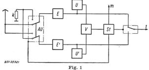
Prinzipschema einer selbsttätig umschaltbaren Empfangsstation einer Hochfrequenz-Richtfunkanlage
