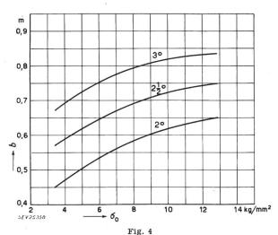
Horizontale Distanz Leitungsachse—Stützpunkt b in Funktion der Zugspannung  $\sigma_0$  und des Zickzackwinkels  $\alpha_0$  als Parameter Die Winkel sind bei den entsprechenden Kurven angegeben Annahmen:  $s_4=35\,$  m,  $l_p=0.42\,$  m,  $\nu=8.9\cdot10^{-3}\,$  kg/m·mm²
