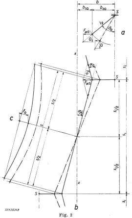
Leitung in Aufriss (a), Grundriss (b) und Seitenansicht (c)
