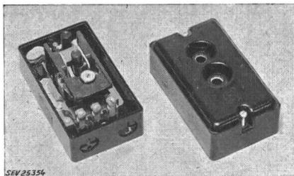
cuivre plaqué d'argent. Socle, traverse de couplage et coffret en matière isolante moulée. Déclencheurs et intensité maximum admissible des fusibles, selon le tableau ci-après:
