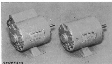
Ces moteurs sont conformes aux «Règles pour les machines électriques tournantes» (Publ. n° 188 f). Utilisation: dans des locaux secs ou temporairement humides.
