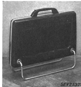
Radiateur, selon figure. Boudins chauffants tirés dans des perles isolantes et disposés dans des rainures entre deux tôles. Enveloppe extérieure en tôle émaillée, avec fentes de ventilation. Commutateur à bascule à deux crans, encastré dans la poignée. Socle de connecteur encastré pour le raccordement de l'amenée de courant. Poignée en matière isolante moulée.
