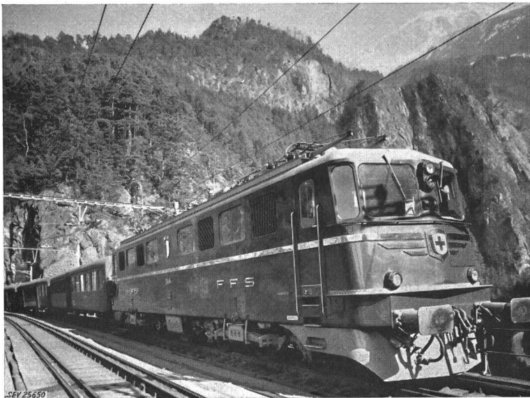
Fig. 9 Lokomotive Ae 6/6 Inbetriebnahme 1952 und später. 120 t, 4400 kW (6000 PS), v_{max} = 125 \text{ km/h}
