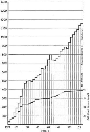
Entwicklung des jährlichen Energiebedarfes und der elektrifizierten Strecken der SBB
