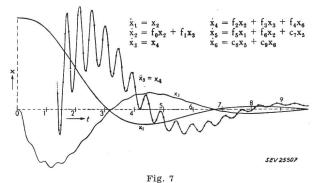
Automatische Integration eines Systems von 6 Differentialgleichungen
