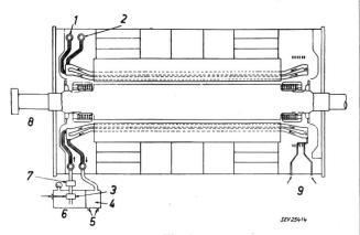
Fig. 8 Coupe d'un turbo-générateur avec enroulement de stator refroidi à l'huile
