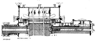
oscillations de 100 Hz du corps du rotor sont dues au moment d'inertie inégal causé par l'encoche et par la corne polaire; on essaie de les réduire en pratiquant des cannelures (fig. 10). Ce qui est très pénible, c'est la dilatation thermique inégale du cuivre et du fer; elle équivaut, pour un changement
