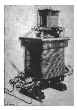
Fig. 1 Machine à courant continu de Wilde avec excitatrice (1866)
