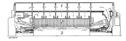
Fig. 4 Turbo-générateur avec ventilation intérieure à l'hydrogène
