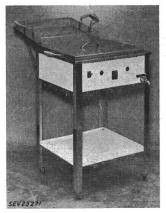
Friteuse pour confiseries, selon figure. Table roulante avec bac à huile en acier inoxydable. La graisse est chauffée par thermoplongeurs constitués par trois chauffants barreaux gaine métallique. Interrupteur tripolaire à bascule, thermostat tripolaire, deux lampes témoins et un robinet de vidange. Bornes de connexion et borne de mise à la terre.
