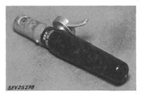
moulée, munie d'une poignée en aluminium. Les électrodes peuvent être introduites latéralement ou en bout.
