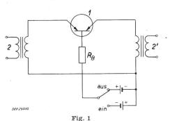
Bilateraler Schalter mit einem symmetrischen p-n-p-Transistor 1 Symmetrischer Transistor; 2, 2' Übertrager;  $R_B$  Basiswiderstand
