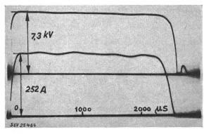
Fig. 3 Kathodenstrahl-Oszillogramm der Prüfung eines Revar-Ableiters
