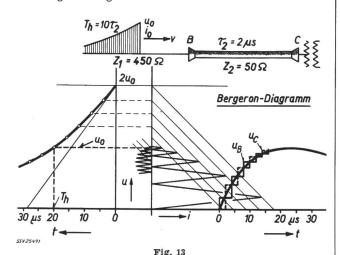
Beanspruchung eines Kabels am Leitungsende (Kavernenkraftwerk) durch Blitzwelle mit  $T_h=10$   $\tau_2$   $T_h$  Halbwertzeit der Blitzwelle;  $u_0$ ,  $i_0$  Amplituden der Blitzwelle; u Spannung;  $u_B$ ,  $u_G$  Spannungen in den Punkten B und C; v Wellengeschwindigkeit Weitere Bezeichnungen siehe Fig. 11
