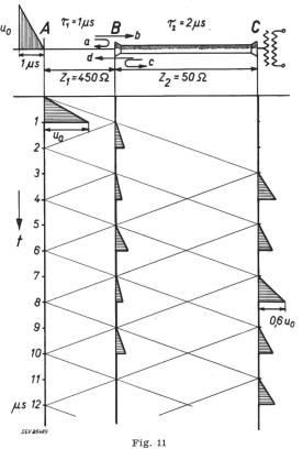
Schutzfunkenstrecke vor einem Kavernenkraftwerk $t_{ij}(u_o)=1~\mu ext{s}$
