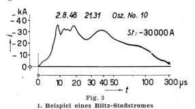
Fig. 3 und 4 geben zwei Beispiele von Stosskomponenten des Blitzstroms und damit der Form der Überspannung auf Holzstangenleitungen beim Einschlagspunkt [2]. Mit einer mittlern Blitzstromsteilheit von 10 kA/μs und einem resultierenden Wellenwiderstand der Holzstangenleitung nach bei-
