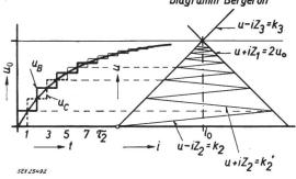
Fig. 14 Beanspruchung eines Kabels im Leitungszug durch lange Blitzwelle  $(T_h \gg au_2)$
