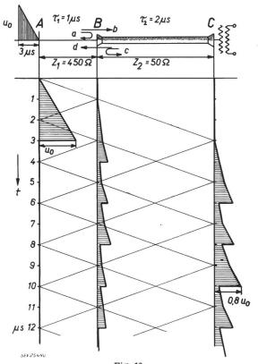
Fig. 12 Schutzfunkenstrecke vor einem Kavernenkraftwerk  $t_a(u_o)=3~\mu {
