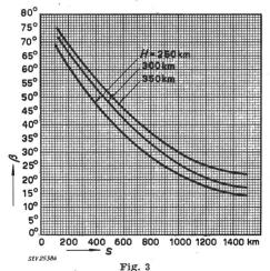
Abhängigkeit des Strahlungswinkels von der Übertragungsentfernung
