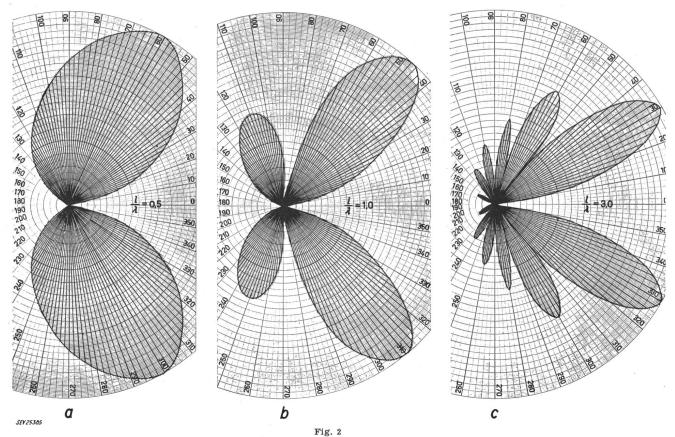
Richtcharakteristik eines Einzelleiters, der von einer fortschreitenden Welle durchflossen wird a bei einem Verhältnis von  $\frac{l}{\lambda}=0.5$  b bei einem Verhältnis von  $\frac{l}{\lambda}=1.0$  c bei einem Verhältnis von  $\frac{l}{\lambda}=3.0$
