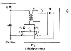
1 Hochspannung; C Speicher- und Messkapazität;  $C_h$  Teiler-kapazität;  $C_n$  Teiler-kapazität;  $D_1$ ,  $D_2$  Eingangsdioden;  $G_1$  Verstärkereingang; R Ladewiderstand
