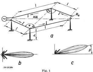
Schema der Rhombusantenne
