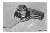
Résistance boudinée, entourant un corps en matière céramique. Carcasse en métal nickelé, avec poignée en matière isolante moulée. Interrupteurs unipolaires à bascule dans la poignée, permettant un fonctionnement à air chaud ou à air froid. Cordon de raccordement de section circulaire, à trois conducteurs, fixé au sèche-cheveux, avec fiche 2 P + T.
