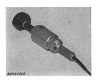
Poignées isolées au caoutchouc. Cordon de raccordement renforcé, à quatre conducteurs. Poids sans le cordon 7,8 kg.
