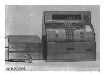
raccordement à conducteurs isolés au caoutchouc, fixé à la caisse, avec fiche  $2\,\mathrm{P}+\mathrm{T}.$  Filtre de déparasitage incorporé.
