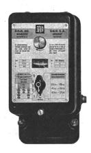
Die neue Spezialschaltuhr Typ DH5 (Fig. 2) enthält einen von vorn gut sichtbaren und zugänglichen Programm-Handschalter, mit dem auch der Laie ausser der Sperr-, d. h. Nullstellung, fünf verschiedene Zeitprogramme wählen kann. Wird der Apparat in einer Ölfeuerungsanlage verwendet, so
