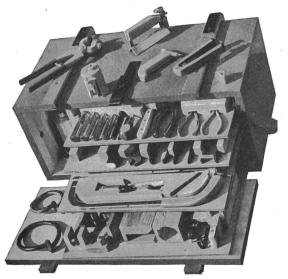
Fig. 1 Montagekiste für Kunststoffkabel
