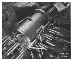
Fig. 3 Gehäuse des modernen Oerlikon-Motors bei der Bearbeitung auf dem Vielfachspindel-Bohrwerk
