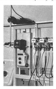
Fig. 2 Photoelektrisches Zählerprüfgerät zur Ausschaltung von Beobachtungsfehlern bei der Eichung
