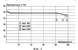
Strom-Spannungscharakteristik eines Gleichrichters nach dem Westat-Prinzip
