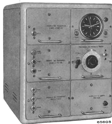
Fig. 2 Horloge à quartz Précision garantie 10^{-7}
