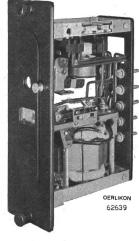
es durch Selbsterregung des Generators kommen. Oerlikon hat eine Selbsterregungsschutz-Einrichtung geschaffen, bei der ein einpoliges wattmetrisches Relais Typ MW 1 anspricht, sobald der kapazitive Anteil des Generatorstromes eine bestimmte Grösse erreicht. Die Spannungsspule ist über einem Spannungswandler an die verkettete Generatorspannung, die Stromspule an einen Zwischenwandler angeschlossen. Dieses
