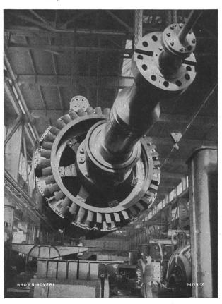
Fig. 1 Rotor eines horizontalachsigen Dreiphasengenerators von 52,5 MVA bei 428 U./min für das Maschinenhaus Rothenbru nen (GR) der Kraftwerke Zervreila A.-G., St. Gallen
