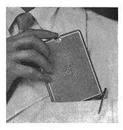
Fig. 2 Empfänger der drahtlosen Personensuchanlage «Individuel»
