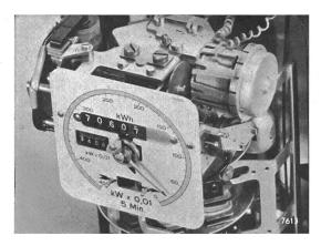
Fig. 1 Maximumzählwerk für kumulative Maximumregistrierung (abgedeckt)
