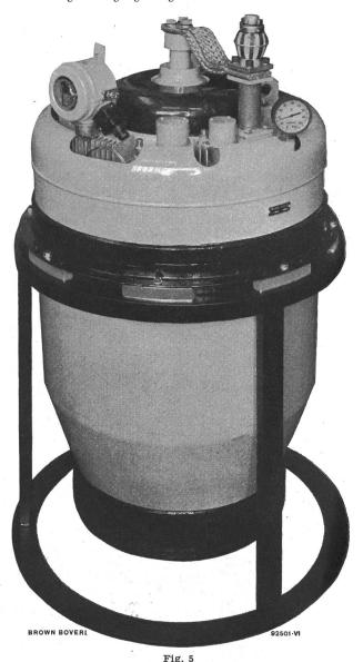
Luftgekühlter, pumpenloser Einanoden-Mutator Typ Lgg für 600 A mit zwei eingebauten Steuergittern für Gleich- und Wechselrichterbetrieb, geeignet für stationäre Bahnunterwerke und für Fahrzeuge mit Energierückgewinnung
