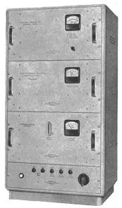
Fig. 1 Générateur étalon à quartz Précision garantie 10<sup>-8</sup>
