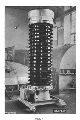
Messgruppe für eine maximale Betriebsspannung von 245 kV mit kapazitivem Spannungswandler
