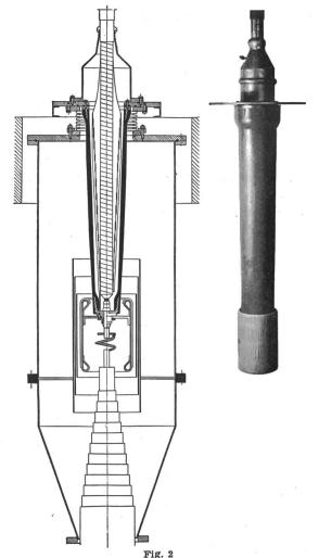
225-kV-Transformator-Endverschluss mit Giessharzisolator
