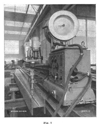
Neuer Zweidraht-Lichtbogenschweissautomat Typ U 1200 im Einsatz in einer schweizerischen Stahlbau-Grossfirma beim Schweissen von Stahlträgern
