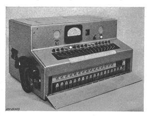
Fig. 1 Mess- und Prüfautomat für Telephonteilnehmerstationen
