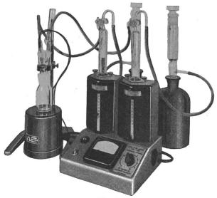
Fig. 3 Dead-Stop-Gerät mit Kolbenbüretten
