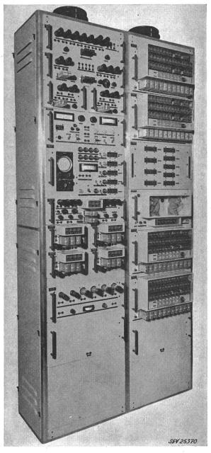
Fig. 3 Equipements destinés à la détection et à la correction automatique des erreurs de signes (équipements TOR) assurant d'excellentes communications au téléscripteur avec les pays d'outre-mer
