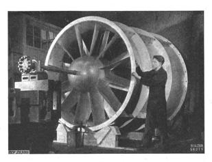
Fig. 2 Sulzer-Propeller-Ventilator von 2 m Durchmesser mit einstellbaren Schaufeln
