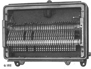
Fig. 2 Dreissigpoliger Programmschalter für Fixprogramm
