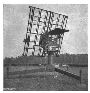
Fig. 1 Equipement de radiorepérage à station unique récepteur permettant d'évaluer les constantes météorologiques
