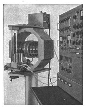
Fig. 1 Kerninduktions-Spektograph
