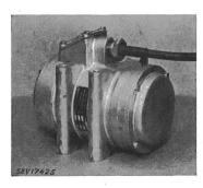
Ce vibreur est conforme aux «Règles pour les machines électriques tournantes» (Publ. n° 188 f). Utilisation: dans des locaux mouillés.
