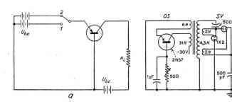
Fig. 1 Schaltung des Gleichspannungswandlers
