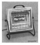
Appareil pour irradiations ultraviolettes et infrarouges, selon figure. Brûleur de quartz et deux résistances de chauffage, logés dans un réflecteur en métal léger. L'une des résistances sert également à la stabilisation du brûleur. Boîtier en tôle avec grille de protection, qui peut pivoter verticalement dans un support. Deux interrupteurs à bascule pour le fonctionnement à UV + IR ou à IR. Poignées en
