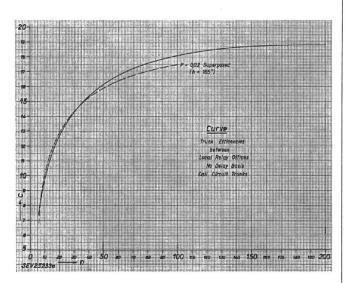
Fig. 2 Leistung von Verbindungsleitungen für Orts-Zentralen, 1902 c Anzahl Gespräche pro Verbindungsleitung (in der Hauptverkehrsstunde); n Anzahl Verbindungsleitungen
