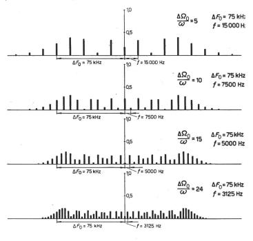
Fig. 1 Seitenbandspektren von FM-Schwingungen
