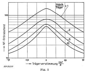
NF-Störabstand bei Impulsstörungen eines FM-Empfängers als Funktion der Trägerverstimmung gegen die Bandmitte 1300 Störimpulse/s
