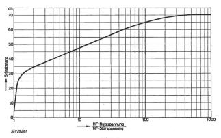
Fig. 9 Unterdrückung eines Störsenders durch den stärkeren Nutzsender
