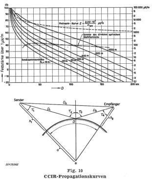
Quadratische Mittelwerte bezogen auf einen Halbwellen-Sendedipol und 1 kW Strahlungsleistung Horizontalpolarisation: f=100 MHz;  $\lambda=3$  m;  $\epsilon=10$ ;  $\sigma=10^{-13}$  Empfangsantennenhöhe:  $h_2=10$  m  $\tau_1...\tau_4$  Winkelgrössen definiert durch die Figur  $D_0$  Distanz Sender—Empfänger
