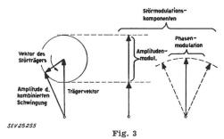
Störcharakteristik eines diskreten unmodulierten Störträgers 100~% Phasenmodulation sei  $\pm~1$  rad, d. h. eine Phasenabweichung, die dasselbe Frequenzband beansprucht wie eine amplitudenmodulierte Übertragung mit identischem Nachrichteninhalt
