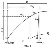
Zeitlicher Verlauf der Spannungen nach plötzlichem Anlegen einer Überspannung
