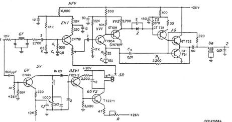
gebiet von 20...70 MHz überstreicht, und einem Transistor-ZF-NF-Teil. Die Empfindlichkeit beträgt 12  $\mu V$  an 50  $\Omega$ für einen Geräuschabstand von 10 db. Bei einem Eingangs-
