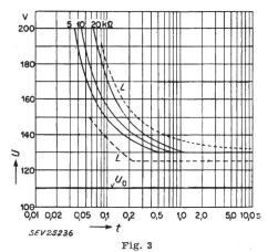
Zeit-Spannungsdiagramm des Überspannungsrelais Parameter: Widerstand des Potentiometers  $P_2$  U Effektivwert der Phasenspannung;  $U_0$  Nennspannung; t Zeit; t Überspannungsgrenzen
