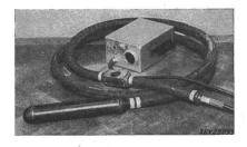
Ce pervibreur à béton a subi avec succès les essais relatifs à la sécurité. Utilisation: en plein air, en liaison avec un transformateur de protection conforme aux prescriptions.
