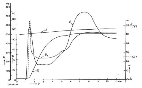
Fig. 2 Startdiagramm des Versuchsreaktors Spert-1
