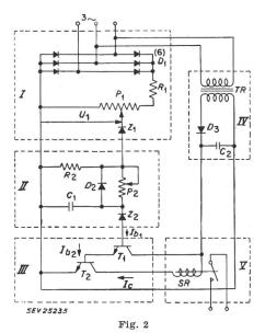
Prinzipschema des neuen Überspannungsrelais
