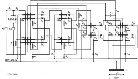
hat jedoch keine Stabilisierungssteuerwicklungen. Die Einstellung des Arbeitspunktes der Magnetverstärker erfolgt über einen Teil der Arbeitswicklung, welche z.B. beim Magnetverstärker  $MV_1$  über den Widerstand  $R_3$  und über den Gleichrichter  $G_7$  gespeist wird.
