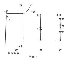
Strom-Spannungscharakteristik und Ersatzschema der Zener-Diode
