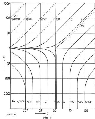
Absoluter Betrag k der relativen Impedanz als Funktion der relativen Kreisfrequenz v und der reziproken Dämpfung u
