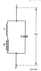
Die Resonanzkreisfrequenz  $\omega_{0r}$  soll, unter Berücksichtigung des Verlustwiderstandes, so definiert werden, dass in Gl. (1) für  $\omega_{0r}$  der Imaginärteil von Z verschwinde:
