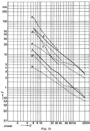
Eigenfrequenzen f nach Tabelle II, die den vorgeschlagenen Steilheiten der wiederkehrenden Spannung entsprechen
