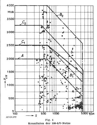
Reminite der 100-KV-Netze  $P_{cN}$  Kurzschlussleistung der Netze; S Steilheit A System A: P < 2000 MVA;  $B_1$  System B:  $P \le 2500$  MVA;  $B_2$  System B:  $P \le 4000$  MVA;  $C_1$  System C:  $P \le 2500$  MVA;  $C_2$  System C: P < 3500 MVA Bezeichnung der Messwertpunkte siehe in der Tabelle unter Fig. 8
