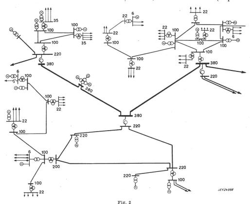
Prinzipielles Schema, welches die Art des Aufbaues des tschechoslowakischen Versorgungssystems veranschaulicht Die Zahlen bedeuten Spannungen in kV
