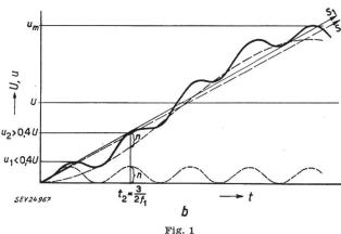
Vergleich der Steilheiten mehrfrequenter Verläufe, welche einerseits nach den Regeln der CEI und anderseits auf Grund der vorgeschlagenen vereinfachten Methode bestimmt wurden
