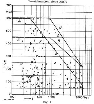
Kennlinien der 6-kV-Netze A System A: P < 450 MVA;  $A_1$  System A:  $P \le 600$  MVA; B System B: P < 450 MVA;  $B_1$  System B:  $P \le 600$  MVA Bezeichnungen siehe Fig. 4
