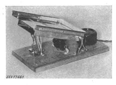
prise de courant pour le fer à repasser. Cordon de raccordement torsadé, avec fiche 2 P. Ce support est également livrable avec amenée de courant à trois conducteurs et fiche 2 P + T, ainsi qu'une prise. Surface d'appui de  $120\times170$  mm, à 50/110 mm au-dessus de la plaque de base.
