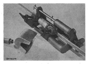
Fig. 19 Appareil à souder pour soudage aluminothermique (Alutherm)
