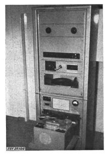
Fig. 6 Tourne-disques et magnétophone
