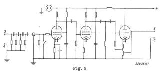
Schaltschema des Vorverstärkers 5, 6 Anschlussklemmen für den Hochleistungsverstärker (s. Fig. 9) Weitere Bezeichnungen siehe Fig. 5
