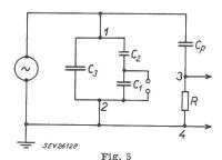
Für den Messapparat verwendetes Schema 1, 2 Klemmen des Prüflings; 3, 4 Klemmen zur Abnahme des aperiodischen Impulses;  $C_p$ , R Kondensator und Widerstand des Hilfskreises
