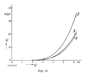
Spezifische Leistung der Ionisierungsvorgänge  $P_i$  in Abhängigkeit von der Spannung U gemessen an den Phasen  $X,\,Y,\,Z$  eines hydroelektrischen Generators 25 MVA, 10,5 kV mittels der beschriebenen Apparatur
