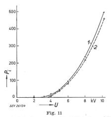
Ionisationsverlust  $P_i$  (bezogen auf 1  $\mu F$  Kabelkapazität) in Abhängigkeit von der Spannung U am Kabel, gemäss Messungen mit einer Scheringbrücke (Kurve 1) bzw. mit Wattmeter des Ionisationsgerätes (Kurve 2)
