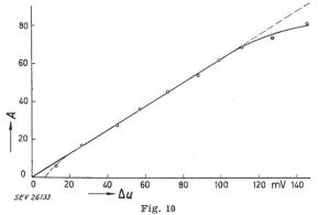
Gemessene Abhängigkeit des Wattmeterausschlages A von der Amplitude des Spannungsimpulses  $\Delta u$
