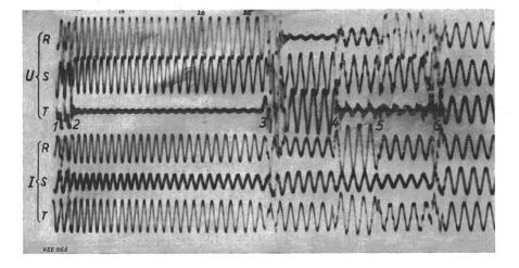
Fig. 3 Oscillogramme de la perturbation dans le réseau à 150 kV
