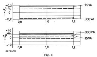
Erreur de rapport  $F_U$  et déphasage  $\delta_U$  d'un transformateur de tension pour 220 kV à noyau en forme de barreau, avec compensation, dans les limites de la classe 0,2,  $\cos \beta = 0,8$  (VDE)
