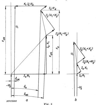
Diagrammes vectoriels de transformateurs de tension a Avec noyau en forme de barreau et compensation du déphasage
