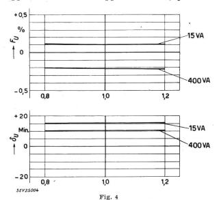
Erreur de rapport  $F_U$  et déphasage  $\delta_U$  d'un transformateur de tension pour 220 kV à noyau en forme de barreau, sans compensation, dans les limites de la classe 0,5,  $\cos\beta=$  0,8 (VDE)
