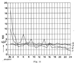
Sollicitation électrique des bobines primaires d'un transformateur de tension pour 220 kV à noyau en forme de barreau, par un choc normal 1 | 50, en fonction du numéro de la bobine
