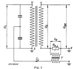
Schéma d'un transformateur de tension avec compensation
