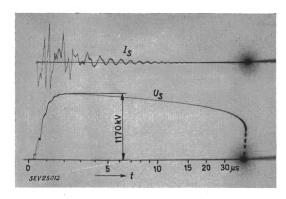
Fig. 12 Oscillogramme relevé au cours de l'essai d'un transformateur de tension pour 220 kV
