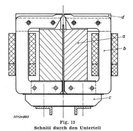
a Anschlußschienen; b Kernpaket; c Jochpaket; d Kontaktstück
