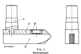
a Profilstück; b Polpaket; c Anschlussbolzen;
