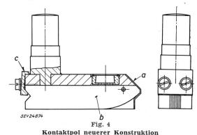
a Abdeckblech; b Polpaket; c Klemmbride für das Polpaket
