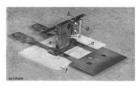
Fig. 18 Einbaufertiges Ankersystem Maßstab 1:2,5
