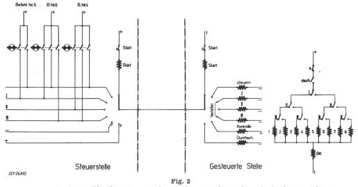
Steuerung mit Kombinationsschaltung in Verbindung mit synchron laufenden Verteilern Anzahl Verteilerschritte = n; Anzahl mögliche Kombinationen =  $2^n$ ; I, II, III . . . Verteilerschritte
