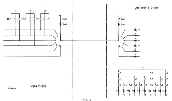
Kombinationsschaltung, bei der für jede Steuerung gleichviel Impulse verwendet werden Anzahl Impulse = k; Anzahl Verteilerschritte I, II, III... = n; Anzahl mögliche Kombinationen =  $\binom{n}{k}$  für n=5 k=3  $\binom{n}{k}=\frac{5\cdot 4\cdot 3}{1\cdot 2\cdot 3}=10$
