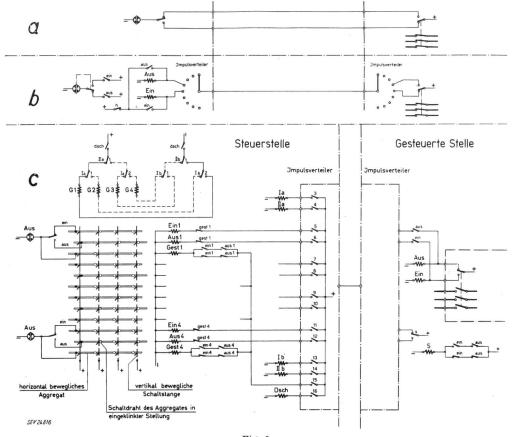
Fig. 9 Schalterstellungsrückmeldung Bezeichnungen siehe im Text
