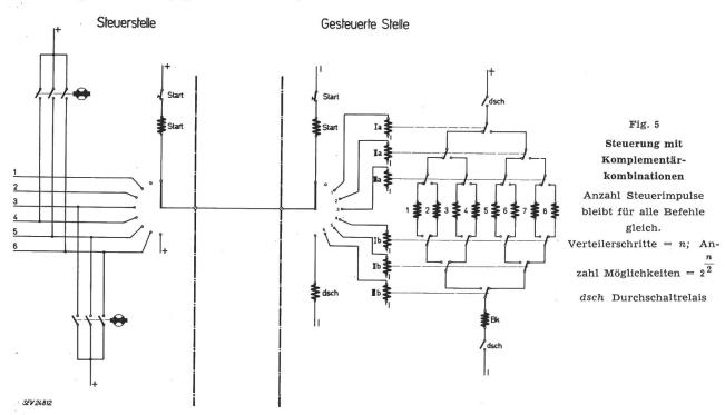
gingen die Bestrebungen dahin, ein System zu finden, welches die Anwendung solcher Kontrolleinrichtungen unnötig macht und die Sicherung der Anlage bis zum steuernden Organ gestattet. Die in der Figur für 8 Befehle dargestellte Schaltung darf deshalb ohne weitere Kontrolleinrichtungen verwendet werden. Jede Verschiebung in der Lage der Steuerimpulse, verursacht durch Stör-
