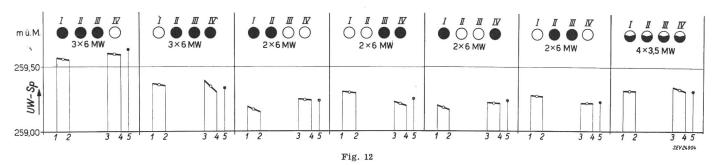
Quergefälle in den Turbinenausläufen bei verschiedenen Beaufschlagungen
