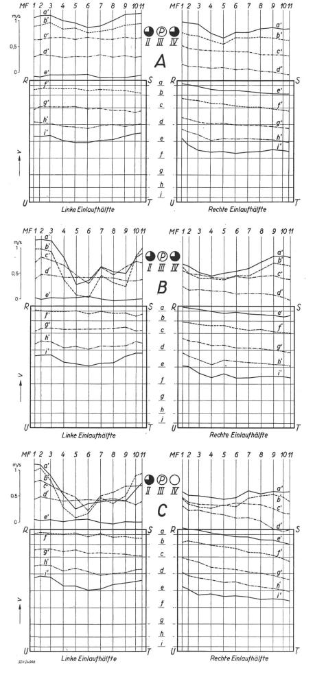
Fig. 8 Geschwindigkeitsverteilung der beiden Einlaufhälften der Turbine III für die Messreihen A...C
