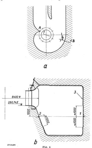
Anordnung der Messbohrungen für die Abnahme des Differenzdruckes
