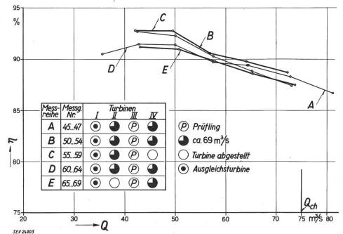
und des Auslaufes auf den Turbinenwirkungsgrad bei kleinerer Fallhöhe relativ zunehmen. Wiederholungsmessungen im Kraftwerk Grossraming mit seiner Ausbaufallhöhe von 23,75 m haben z. B. merklich geringere Abweichungen als die in Mühlrading festgestellten ergeben.
