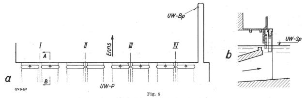
Messanordnung für die Erfassung der Unterwasser-Spiegellagen I, II, III, IV Turbinen; UW-P Unterwasser-Podium; UW-Bp Unterwasser-Betriebspegel a Grundriss b Schnitt A—B in a UW-Sp Unterwasserspiegel;
