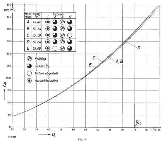
$\triangle h/Q$ -Zuordnungen der Turbine III bei wechselnder Beaufschlagung der Nachbarturbinen A, B, C, D, E Messreihen;  $\triangle h$  Differenzdruck; Q Durchfluss (unmittelbar aus Flügelmessung ermittelt);  $Q_{ch}$  Vollast
