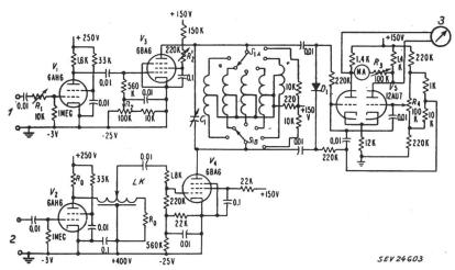
Fig. 1 zeigt das Prinzipschema des Phasenmessgerätes. Das Messgerät hat zwei Eingänge für die Spannungen  $U_1$  und  $U_2$ , deren Phasenunterschied gemessen werden soll. Der Phasenwinkel wird mit einer variabeln Laufzeitkette bestimmt. Diese besteht aus einer Toroidspule, deren Windungen definierte Kapazitäten gegen Masse haben. Die Spule muss sehr gleichmässig gewickelt sein, um eine gute Linearität der
