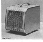
Radiateur soufflant, selon figure. Grille chauffante disposée verticalement dans un bâti en tôle et protégée par des barreaux et un grillage. Ventilateur situé derrière la grille chauffante et entraîné par moteur monophasé autodémarreur, à induit en courtcircuit. Thermostat inséré entre le corps de chauffe et le moteur. Lampe à incandes-
