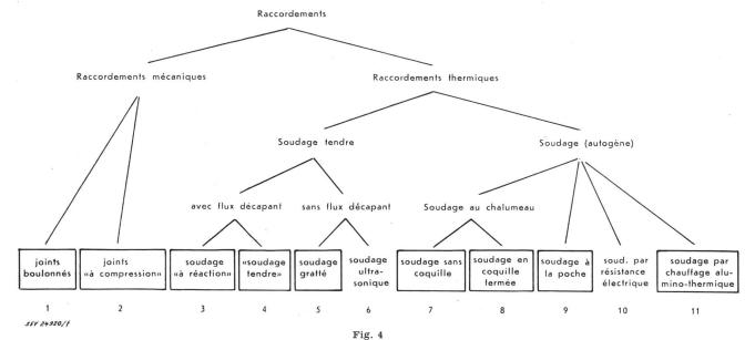
Les méthodes de raccordement applicables aux fils d'aluminium
