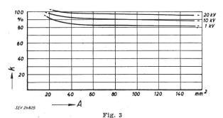
Rapport entre les poids de câbles avec conducteurs en cuivre et en aluminium
