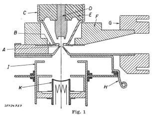
Schnitt durch die Elektrodenanordnung
