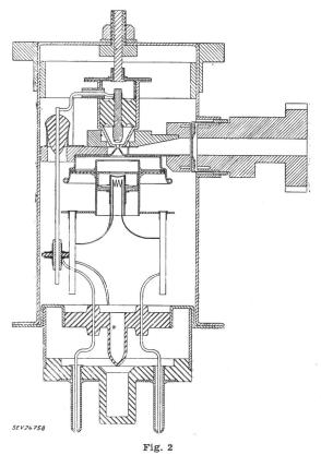
Schnitt durch das Klystron VX 5023: ohne Antriebsmechanismus
