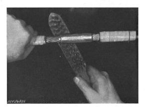
Soudure exécutée d'après la méthode «à réaction»
