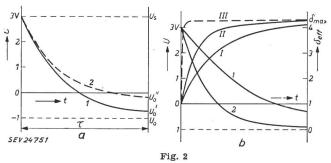
Potential eines Speicherplattenelementes sowie mittlere Anzahl sekundärer Elektronen als Funktion der Zeit
