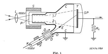
Schematischer Längsschnitt durch das Zwischenbildikonoskop L Linse; P Photokathode; S Spule der magnetischen Elektronenlinse; T Speicherplatte (Glimmer); C Kollektor; E Elektronenabtaststrahl des Strahlerzeugungssystems, von dem nur die Glühkathode K gezeichnet ist; F Fokussierspule; D Ablenkspulen; SP Signalplatte; R, Signalwiderstand
