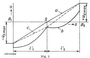
Spannungsverlauf in der Feinregelperiode zwischen zwei Fahrstufen
