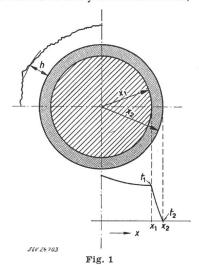
Querschnitt eines isolierten Leiters mit charakteristischem Temperaturgefälle von  $t_1$  auf  $t_2$  in der Isolation
