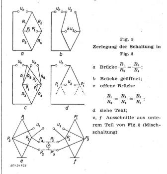
Fig. 9c ist gleich Fig. 9b, aber so geändert, dass  $U_h$  und  $U_2$  parallel und entkoppelt auf  $P_1P_1'$  wirken. Diese Figur zeigt, dass trotz früheren Bemerkungen, wonach  $U_2$  in Serie zu der Modulationsspannung vor den Rechteckumformern «eingreifen» müsse, die Schaltung doch so gewählt werden kann, dass  $U_2$  unabhängig von  $U_h$  an  $P_1P_1'$  eine Wirkung erzeugt.
