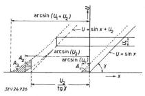
Fig. 16 Sinusförmige Modulationsspannung, deren Flankensteilheit sich ändert Bezeichnungen siehe im Text
