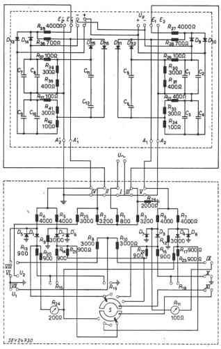
Fig. 10 Schaltbild des Dioden-Wattmeters
