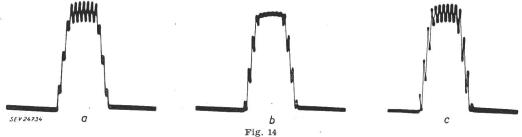
Messoszillogramme für die Fälle in Fig. 12 und 13, wenn die Messfrequenz höher als die Modulationsfrequenz ist
