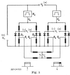
Prinzip eines Dioden-Multipliziergerätes
