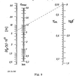
Abaque pour la détermination de la portée maximum possible  $\sigma_B$  Tension maximum admissible au point d'appui supérieur, en kg/mm²;  $\gamma$  Poids rapporté du conducteur avec charge additionnelle, en kg/m·mm²; tg $\beta$ ′ Inclinaison de la tangente au milieu de la portée;  $\tau_{ex}$ . Valeur auxilaire selon définition particulière
