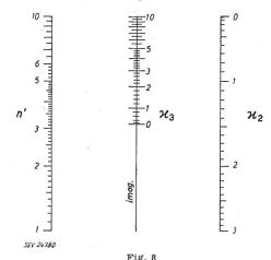
Abaque pour la détermination de la valeur auxiliaire  $\kappa_3$  n' Rapport entre le poids du conducteur chargé n fois et celui du conducteur avec charge additionnelle normale;  $\kappa_2$  et  $\kappa_3$  Valeurs auxiliaires selon définitions particulières
