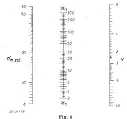
Abaque pour la détermination de la valeur auxiliaire  $\kappa_1$  v Rapport entre la charge additionnelle normale et le poids propre du conducteur;  $\sigma_{m~adm.}$  Tension admissible au point de fléchissement maximum, en kg/mm², pour une sécurité normale;  $\kappa_1$  Valeur auxiliaire selon définition particulière
