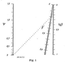
Abaque pour la détermination de la valeur auxiliaire  $\beta''$  $tg\beta$  Inclinaison de la portée;  $\psi$  Caractéristique de la portée; β" valeur auxiliaire selon définition particulière
