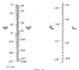
Fig. 10 Abaque pour la détermination de l'inclinaison de la tangente  $tg\beta'$  au milieu de la portée  $tg\beta$  Inclinaison de la portée;  $\tau_{ex}$  et  $\psi_{ex}$ . Valeurs auxiliaires selon définitions particulières
