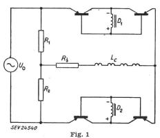
Prinzipschema des Transistorendemodulators
