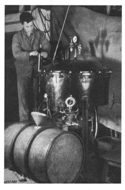
Fig. 5 Cuve pour régénérer les huiles par mélange avec une terre spécialement activée
