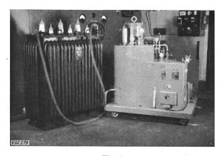
Fig. 4 Appareil pour sécher sous vide et filtre les huiles en circuit fermé
