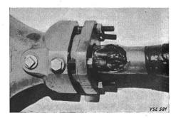
Fig. 6 Claquage d'un câble par assèchement sous la boîte d'extrémité
