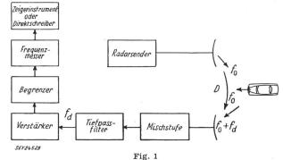
Radar-Geschwindigkeitsmesser, beruhend auf den Doppler-Effekt
