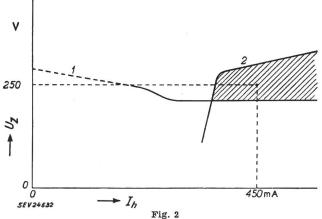
Zündspannung  $U_z$  als Funktion des Heizstromes  $I_h$  1 Zündspannung bei der niedrigsten Umgebungstemperatur (—15 °C), bei der die Lampe noch zünden muss (unter Berücksichtigung eines Sicherheitsfaktors, der die Streuung zwischen den einzelnen Lampen und die Netzspannungsschwankungen berücksichtigt); 2 Grenze, unter der die Zündspannung bleiben
