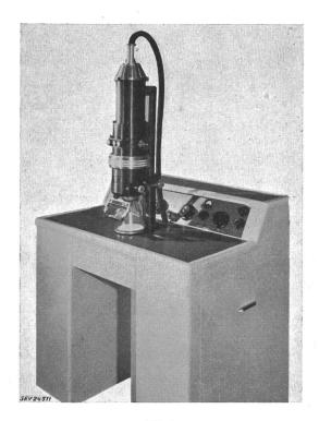
Fig. 1 Elektronenmikroskop vereinfachter Bauart EM 75 kV (Typ 11 981)
