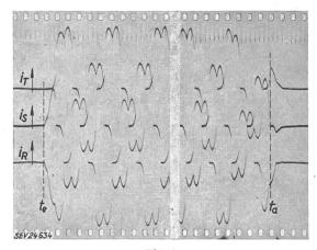
Fig. 6 Stromoszillogramm eines Drei-Phasen-Brückengleichrichters mit magnetisch gesteuerten Kontakten Schaltung nach Fig. 2
