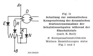
ist, dass im Dauerbetrieb Schaltströme von 0...200 mA für Drosselspulen mit 50 kVA Nennleistung erreicht werden können.
