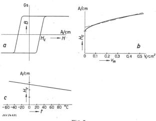
Fig. 7 Charakteristische Kurven des üblichen Kernmaterials für Schaltdrosselspulen
