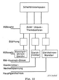
Blockschema der Ausschaltvormagnetisierung, mit statischem Anteil und drei Korrekturkomponenten
