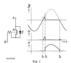
Steuerbarer Kontakt als Verstärkung eines echten Ventils Liniendiagramm der Verwendung des Zweipols als Einweggleichrichter
