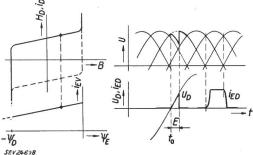
Fig. 10 Hilfsgleichrichter zur Erzeugung von 6 Einschalt-Vormagnetisierungsimpulsen
