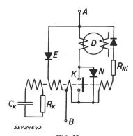
Fig. 15 Haltemagnet mit RC-Kreis zur Dämpfung der Öffnungsbewegung
