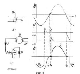
Magnetisch gesteuerter Kontakt mit Schaltdrosselspule D und Hauptstromhaltewicklung, im Liniendiagramm als Einweggleichrichter
