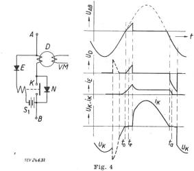
Magnetisch gesteuerter Kontakt mit Schaltdrosselspule und Hilfsstromhaltewicklung, im Liniendiagramm als Einweggleichrichter (nach E. Rolf)
