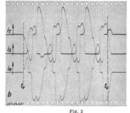
Stromoszillogramm eines Drei-Phasen-Brückengleichrichters mit magnetisch gesteuerten Kontakten
