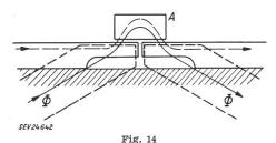
Darstellung der Kontaktgegend mit beweglichem Kontakt A und zwei nachgiebigen Gegenkontakten  $\Phi$  Flussverlauf des Einschalt- und Haltemagneten
