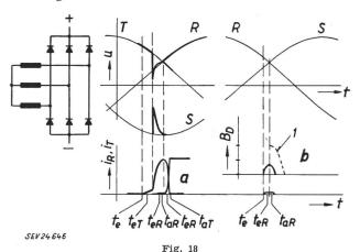
Kommutationsverhältnisse bei Zuschaltung niederinduktiver Last an dreiphasigen Schaltgleichrichtern
