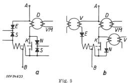
Kontaktsteuerung erweitert für verzögertes Einschalten bei a mittels Steuerventilen S, bei b mittels Steuerdrosselspulen V Weitere Bezeichnungen siehe Fig. 1 und 2
