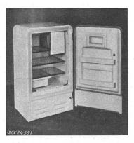
par un relais à la fin du démarrage. Contacteur-disjoncteur séparé. Evaporateur avec enceinte pour tiroir à glace et conserves surgelées. Thermostat ajustable, avec positions de déclenchement et de dégivrage. Extérieur en tôle laquée blanche, intérieur émaillé. Amenée de courant à trois conducteurs, fixée au réfrigérateur. Dimensions intérieures:  $655\times465\times415$  mm; extérieures:  $1050\times600\times525$  mm. Contenance utile: 112 dm³. Poids 80 kg.
