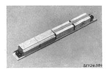
Enroulement en fil de cuivre émaillé sur deux noyaux en fer séparés. Enroulement supplémentaire pour accroître l'intensité du courant de préchauffage. Deux condensateurs en série branchés en parallèle. Condensateur de déparasitage en parallèle avec la lampe. Appareil sans couvercle, uniquement pour montage dans des luminaires en tôle. Bornes sur socle en matière isolante moulée, aux deux extrémités de la plaque de base.
