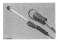
douilles et les oeillets à souder pour l'amenée de courant sont scellés dans un tube en papier bakélisé, logé dans la poignée. Amenée de courant à l'appareil auxiliaire et à la lampe par cordon renforcé (Tdv), dont les conducteurs sont protégés par des gaines isolantes, aux entrées. Introduction des conducteurs dans la baladeuse par des presse-étoupe métalliques.
