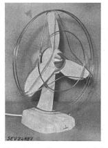
Ventilateur de table oscillant, selon figure, entraîné par moteur monophasé, à induit en court-circuit, avec enroulement auxiliaire et condensateur. Hélice à trois pales de 400 mm de diamètre, carcasse du moteur et socle en matière isolante moulée. Le socle renferme un commutateur et une bobine d'inductance qui permettent d'obtenir trois vitesses de rotation. Le mouvement oscillant du ventilateur peut être supprimé. Cordon de raccordement à deux conducteurs, double gaine isolante. sous
