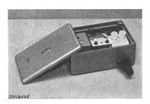
tion par transformateur de réseau à deux enroulements secondaires séparés. Protection du transformateur par deux coupe-circuit normaux dans le circuit primaire et par un petit fusible dans chacun des deux circuits secondaires. Le couvercle du coffret est pourvu d'une ouverture pour l'éclairage de la cellule photoélectrique. Traversées séparées pour les lignes primaires et secondaires.
