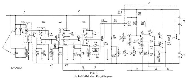
1 Antenne; 2 Oszillator und ZF-Kreise; 3 Detektor; 4 1. NF-Stufe; 5 Steuerstufe; 6 Ausgangsstufe; B Batterie Widerstände in  $\Omega$ , 1/3 W, Toleranz 10 %; Kapazitätswerte in pF, wenn nicht anders vermerkt Transistoren:  $V_1...V_4$  pnp-Versuchstyp;  $V_6$  pnp-Typ 2N34;  $V_0$  pnp-Typ 2N35;  $V_7$  pnp-Versuchstyp;  $V_8$  pnp-Versuchstyp
