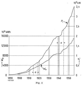
Evolution de 1890 à 1955 de la puissance installée des générateurs et de la productibilité annuelle moyenne de l'ensemble des usines hydro-électriques suisses de plus de 300 kW de puissance installée
