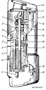
Schnitt durch einen Zweiserie-Unterbrecher, welcher für 138 kV, 161 kV und 230 kV verwendet wird
