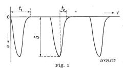
Eingangssignale des Frequenzteilers
