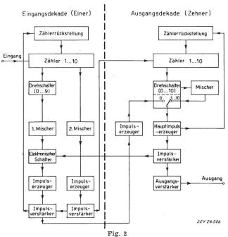
Blockschema eines Frequenzteilers über zwei Dekaden
