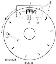
Abtastscheibe für 25 bis 30 vertikale Abtastungen pro Zeichen 1 Bild; 2 radiale Schlitze; 3 Bewegungsrichtung des Bildes; 4 waagrechter Schlitz; 5 Photozelle für Zeitmarkierung;
