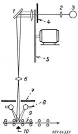
In einer Regelstuse werden die Kontrastdisserenzen für verschiedene Papiere und Druckfarben im Signal elektrisch auskorrigiert, worauf dieses noch beidseitig beschnitten wird. Das Signal enthält eine jedem Zeichen charakteristische Impulsfolge und wird dem Auswerter zugeführt; dieser ent-
