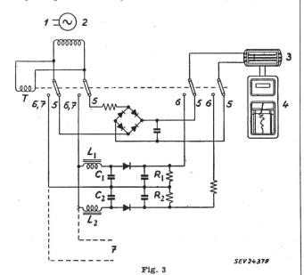
Prinzipschema der Drehzahlmessung
