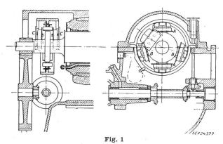
Anordnung der Geber an der Turbine A vertikale Geberspule; B horizontale Geberspule; C axiale Geberspule
