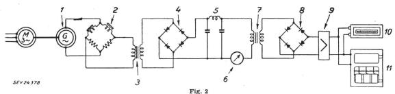
Prinzipschema der Exzentrizitätsmessung
