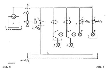
Druckregelung eines Dampfnetzes
