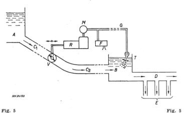
Wasserstandsregelung in einem Ausgleichsbecken
