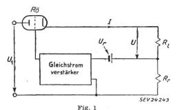
Prinzipschaltung des Gleichstromstabilisators I Gleichstrom durch die Last;  $R_i$  Lastwiderstand;  $R_r$  Bezugswiderstand; Rö Regelröhre; U, Speisespannung; U, Bezugsspannung
