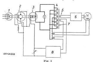
Prinzipschema für die kontinuierliche Verlustmessung ganzer Transformatorblechtafeln
