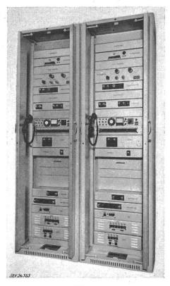
Fig. 2 Einseitenbandgeräte zur Übertragung von 2 Sprechkanälen und überlagerten Fernwirksignalen
