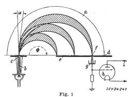
Einfacher Massenspektograph bzw. Massenspektrometer
