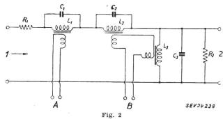
Prinzipschema eines variabeln Bandpasses mit unabhängig verschiebbaren Grenzfrequenzen
