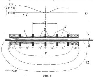
Aufbau und Wirkung der Spulen für die kontinuierliche Messung der Verluste von Transformatorblechtafeln
