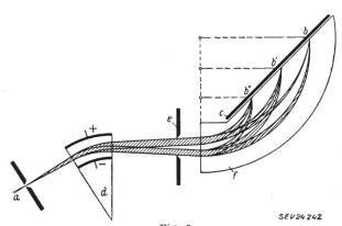
Fig. 2 Doppelfokussierender Massenspektograph (Nach Mattauch und Herzog)
