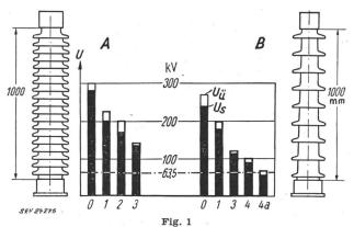
Isoliervermögen von Stützern mit betauten Fremdschichten
