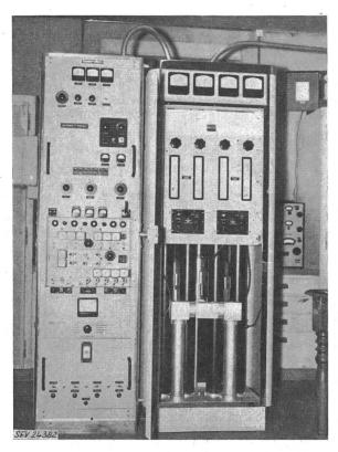
Fig. 1 Frequenzmodulierter UKW-Sender
