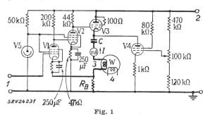
Schema des elektronischen Wattmeters 1 Eingang; 2 stabilisierte Anodenspannung 350 V; 3 Drehspule; 4 Feldspule; 1 Wechselstrom des Kathodenfolgers V3
