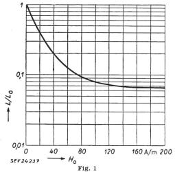
Relative Induktivität  $L/L_0$  einer vormagnetisierten Spule mit Kern hoher Permeabilität in Funktion des angelegten Gleichfeldes  $H_0$
