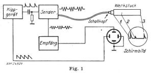
Blockschema der Ultraschall-Materialprüfanlage 1 Sendeimpuls; 2 Fehlerimpuls; 3 Bodenecho
