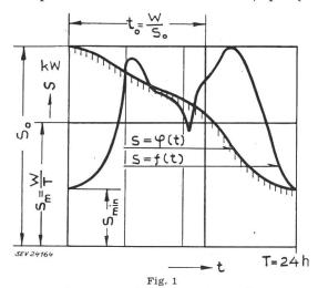
Diagrammes de la charge journalière S Charge; S=f(t) Courbe de marche;  $S=\varphi(t)$  Courbe de durée;  $S_0$  Charge journalière maximum;  $S_{min}$  Charge minimum;  $S_m$  Charge moyenne;  $t_0$  Durée d'utilisation de la charge maximum
