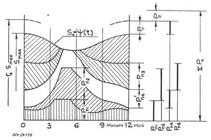
Fig. 16 Plan de charge du système interconnecté  $\begin{array}{ccc} \Sigma P_n & \text{Puissance installée} \\ P_c & \text{Puissance compensatoire} \end{array}$
