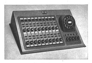
Fig. 1 «Albis»-Chefstation mit in der Neigung verstellbarer Bedienungsplatte
