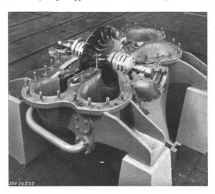
Fig. 1 Einstufiger Sulzer-Radialverdichter
