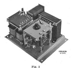
Transduktorregler für kleine Generatoren bis 40 kVA
