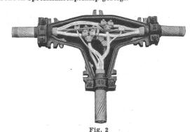
Abzweig eines Tdc-Vierleiterkabels mit Steuerdrähten
