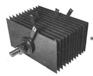
Fig. 1 Selen-Gleichrichter-Element Typ 34 P 18 H
