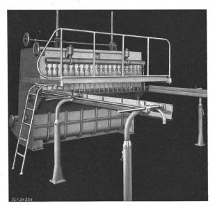
Fig. 1 Stoffauflauf für eine Papiermaschine
