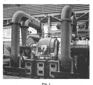
Einstufiges, doppelflutiges Oerlikon-Turbogebläse zum Absaugen der Luft aus dem Reaktor eines Atomlaboratoriums. Förderleistung 35 m³/s bei 0,83...1,03 kg/cm². Antrieb durch Dreiphasen-Käfiganker-Motor 810 kW (1100 PS), 2970 U./min
