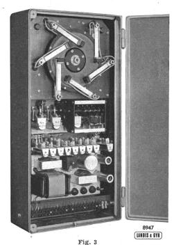
Sprechender Zähler für die Übertragung von Zählerständen über ein Telephonnetz
