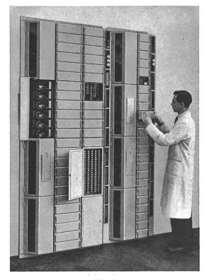
Fig. 2 Wähler- und Relaisausrüstung in steckbarer Ausführung für Vielsprecher-Teilnehmer
