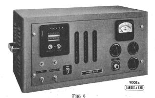
Dekadischer Impulsuntersetzer zur Messung von Strahlungsintensitäten (in Verbindung mit Zählrohren oder Szintillationszählern)
